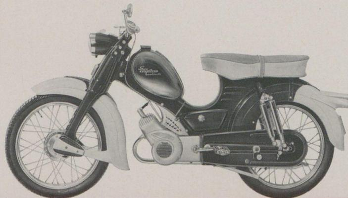
ZUNDAPP-3-Gang-Motor; Gebläse, Zweitakter; 50 ccm, 2,6 PS bei 4800 U/min., Leichtmetallzylinder, Kraftstoff-Olgemisch 25:1. Schwunglicht-Magnetzünder 6 Volt, 18 Watt, dauerabgeblendet; Ziehkeilgetriebe mit 3 Gängen und Leerlauf, Pedalkickstart, Handschtaltung, 3-Scheiben-Ölbakcupplung.
