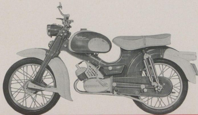
ZUNDAPP-3-Gang-Motor; Zweitakter; 50 ccm, 2,6 PS bei 4500 U/min.; Leichtmetallzylinder, Kraftstoff-Ölgemisch 25:1, Schwunglicht-Magnetzündler 6 Volt 18 Watt, dauerabgeblendet; Ziehkeilgetriebe mit 3 Gängen und Leerlauf, Kickstart, Handschaltung, 3-Scheiben-Ölbadekupplung.
